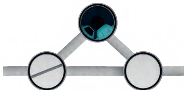
Figur 6. Downstream Defender® Select - ekstern omlægningkonfiguration.
