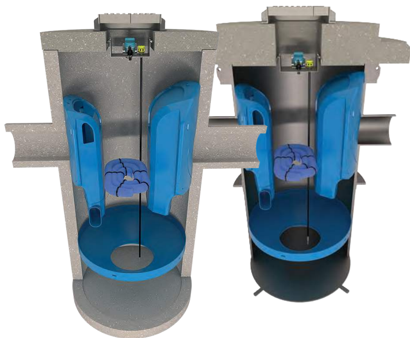
Figur 1. Downstream Defender® Select. Avancerede Vortex-modeller i beton og plast vist med Hydro-Logic® Smart Monitoring og forbedrede olieopsamlingsmuligheder.
